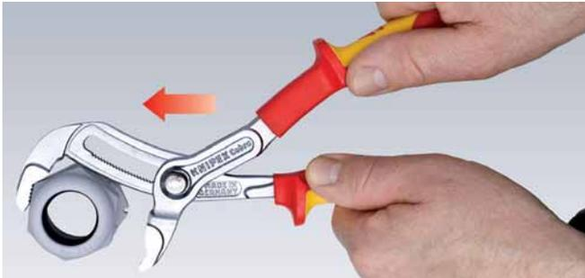
Schnelleinstellung am Werkstück ohne Druckknopfbetätigung
