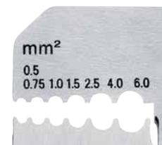
12 21 180: Drahtquerschnitte in mm<sup>2</sup>
