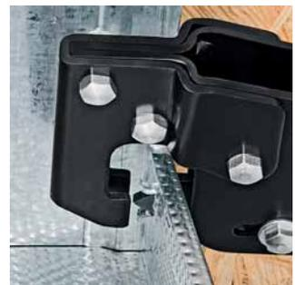
Das Stempelwerkzeug wird durch die Profilbleche gedrückt
