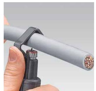
Ansetzen des Werkzeugs für Umfangschnitt
