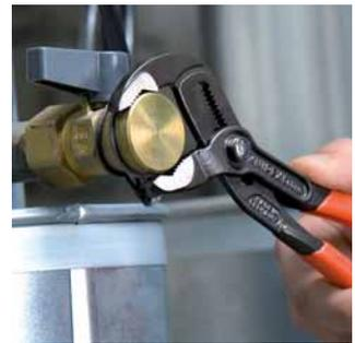
Schnelle und passgenaue Einstellung direkt am Werkstück
