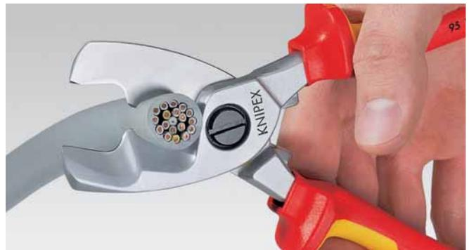
**Nachschnitt:** Nachdem der Mantel des Kabels im vorderen Profil durchgeschnitten wurde, werden die Leiter im hinteren Profil durchtrennt. Vorschnitt vorn, Nachschnitt hinten - so schneidet es sich leichter.
