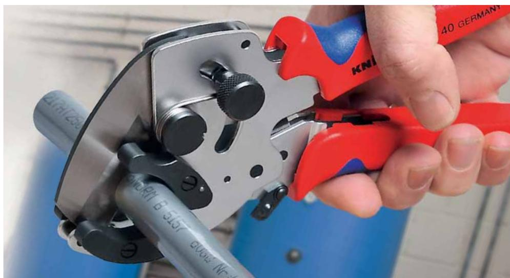
*In Fußbodenheizungen kommen vorwiegend dickwandige Kunststoffrohre zum Einsatz. Mit dem richtigen KNIPEX-Rohrschneider lassen sie sich kraftschonend und exakt zuschneiden.*
